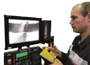
System mit großem Farbbildschirm (15"), Minikamera und zusätzlicher Beleuchtung
