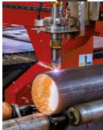
Plasma- schneid- Anlage mit Rohrschneiden
